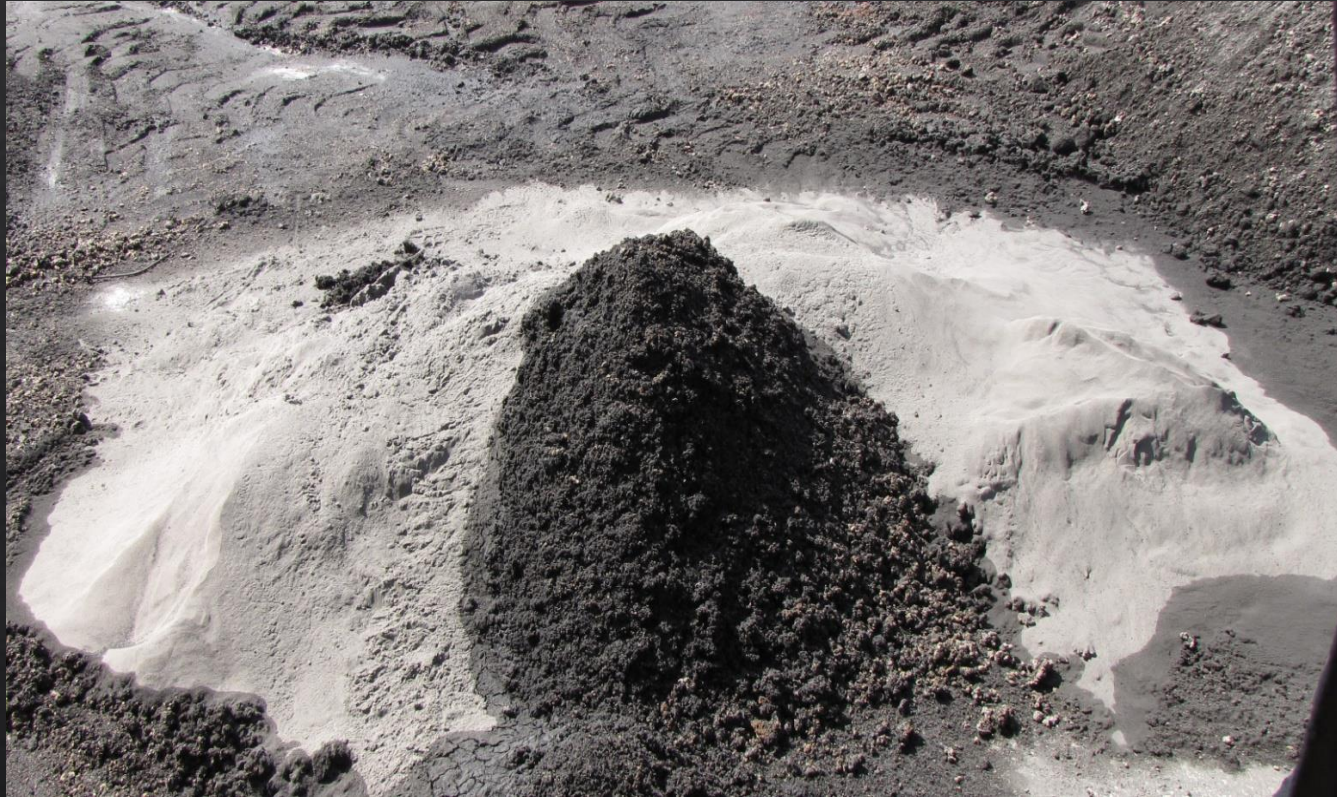
Rys. 25 Drobnny pył uzyskany z odpylaczy w czasie około doby ich pracy. Fotografia własna- kwiecień 2021r.
